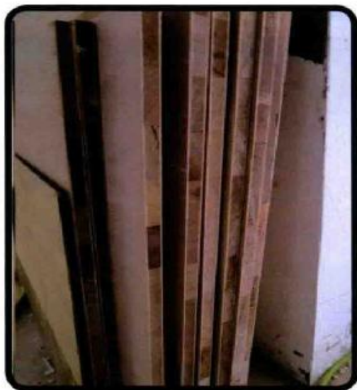
▲ 细木工板是最常见的木工工程材料，由小块的木头高压压制而成。
